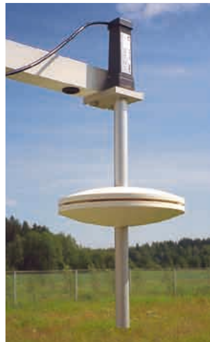
SPH10/20は取り付けが簡単です。写真のSPH10はPTB210気圧計に接続されています。
