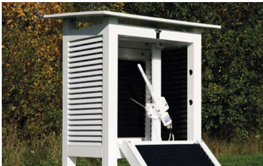
Sonda HMP155 con un nuevo y estable sensor HUMICAP®180R y una sonda adicional de temperatura.
